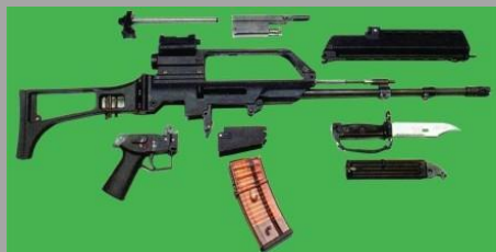
Разобранная винтовка G36
